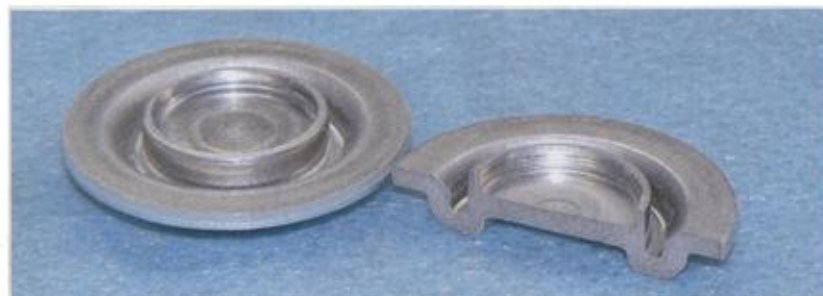
図1●コストを1/10に削減したプレス品
